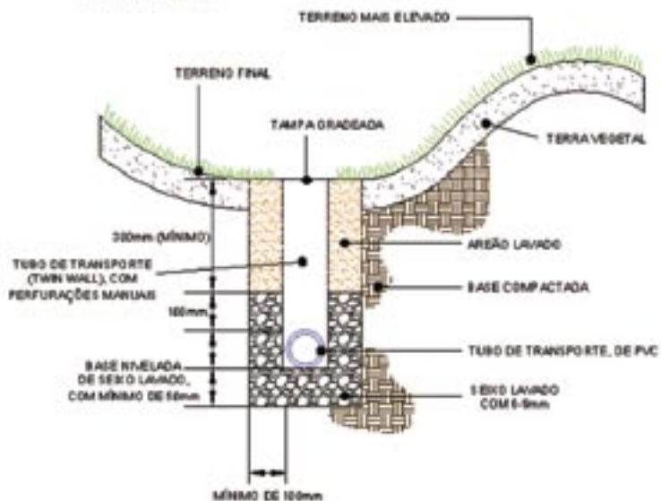
Figura 2.4-7: Plano tipo de drenagem de bunkers
